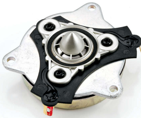
Il tweeter utilizza una calotta posteriore con un piccolo volume accuratamente silenziato. Il piccolo rifasatore anteriore alla membrana in titanio ottimizza la risposta del tweeter alle alte frequenze.
