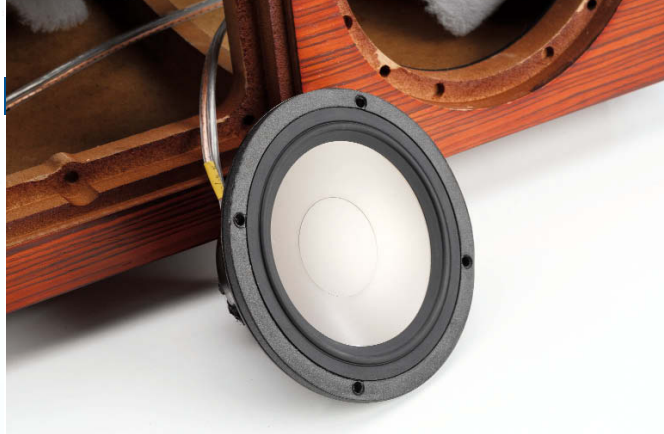
Il midrange è realizzato con una cupola rovesciata di alluminio accuratamente interfacciata con una tromba tractrix che ne controlla la dispersione. È stato necessario un lungo studio di ottimizzazione per ridurre le riflessioni interne ed aumentare il contrasto e la microdinamica.
